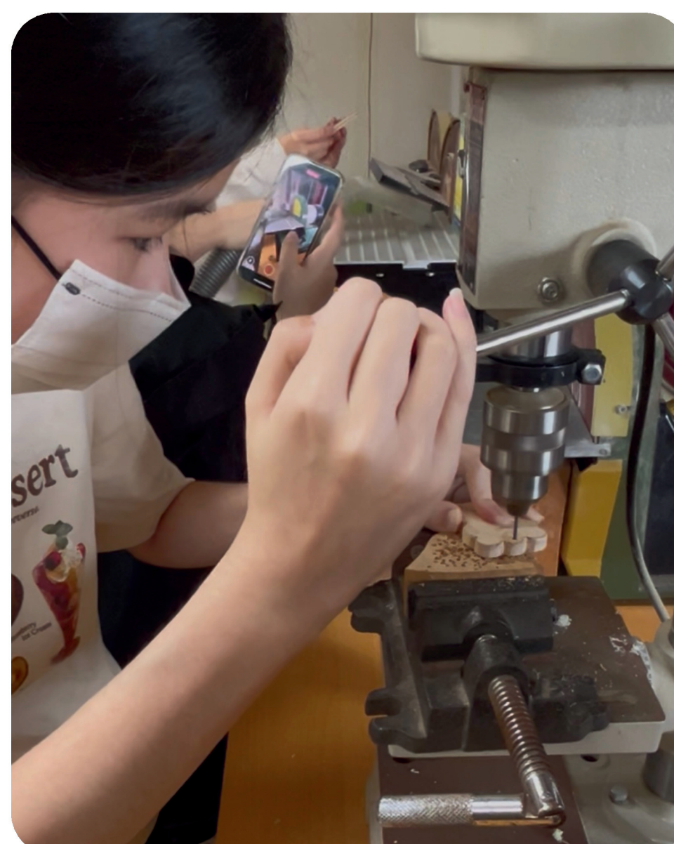
▲ 鑽孔機：鑽出用於吊環的洞
