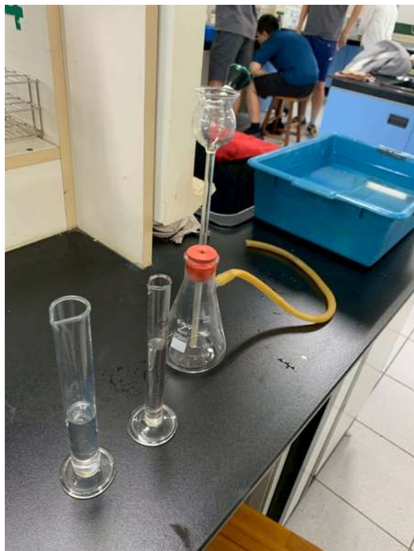
(圖四)排水集氣裝置
