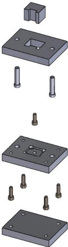
電腦繪製B304模具3D模型，與其他老師提供零件(螺絲、銷)組合之關係
