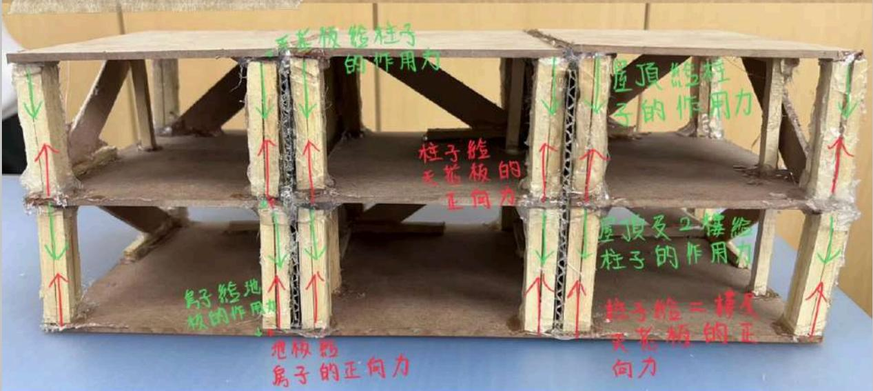
老屋結構力圖 側面
