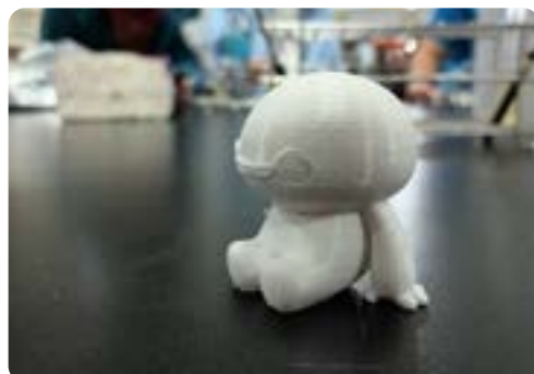
▲將支架拆除後的成品
